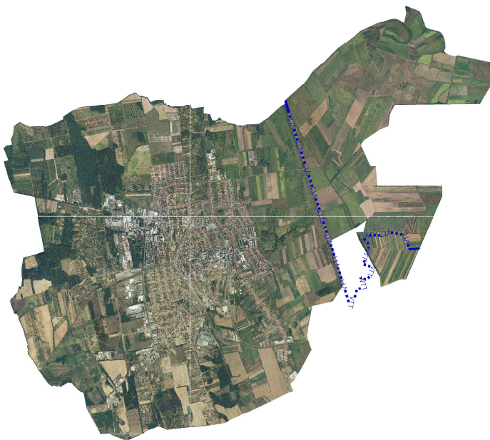
9. ábra: Kék vonallal jelöltük a VTT intézkedési határvonala, vagyis az a vonal, ameddig elöntés esetén a felszint víz borítaná. (Az ábrán lévő határvonal az OTRT rajzai alapján készült saját feldolgozás.)
